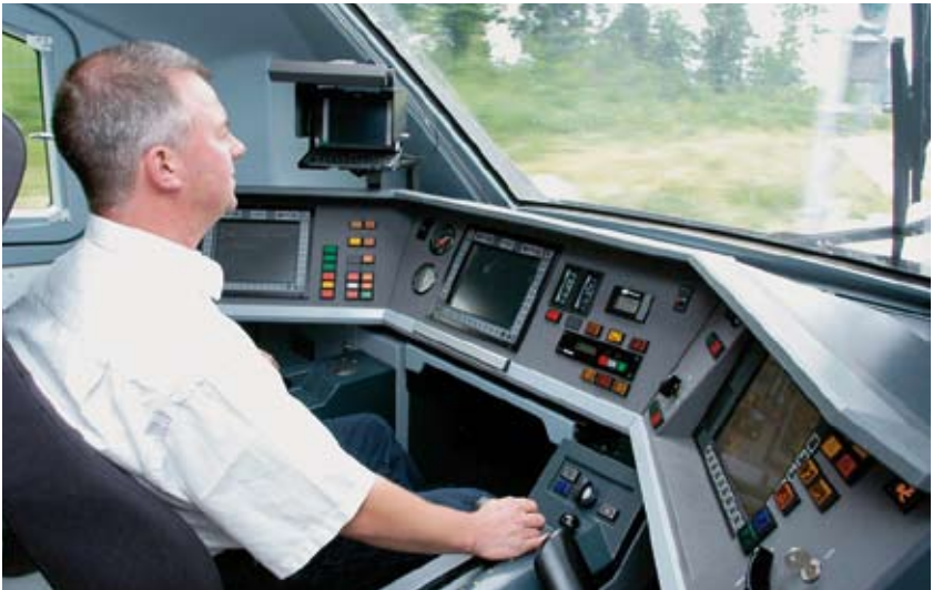
↑ Intercity Neigezug Führerstand ausgerüstet mit GSM-R Technologie (ETCS II).
